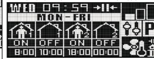
Пример запрограммированного календаря (рабочие дни). Завеса будет включена в 8 часов утра и она будет выключена в 10 часов утра. Новое включение будет в 6 часов вечера, отключение в 00:00. Цикл будет повторяться с понедельника по пятницу.
