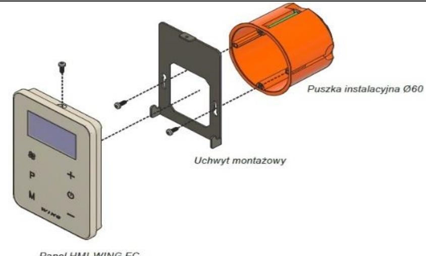
**PL:** W celu prawidłowego podłączenia elektrycznego proszę odnieść się do schematów połączeń elektrycznych kurtyn WING EC.
